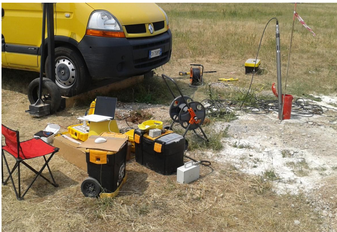
Prospezione sismica in foro con tecnica "down-hole" – Aeroporto militare di Ghedi (BS)
