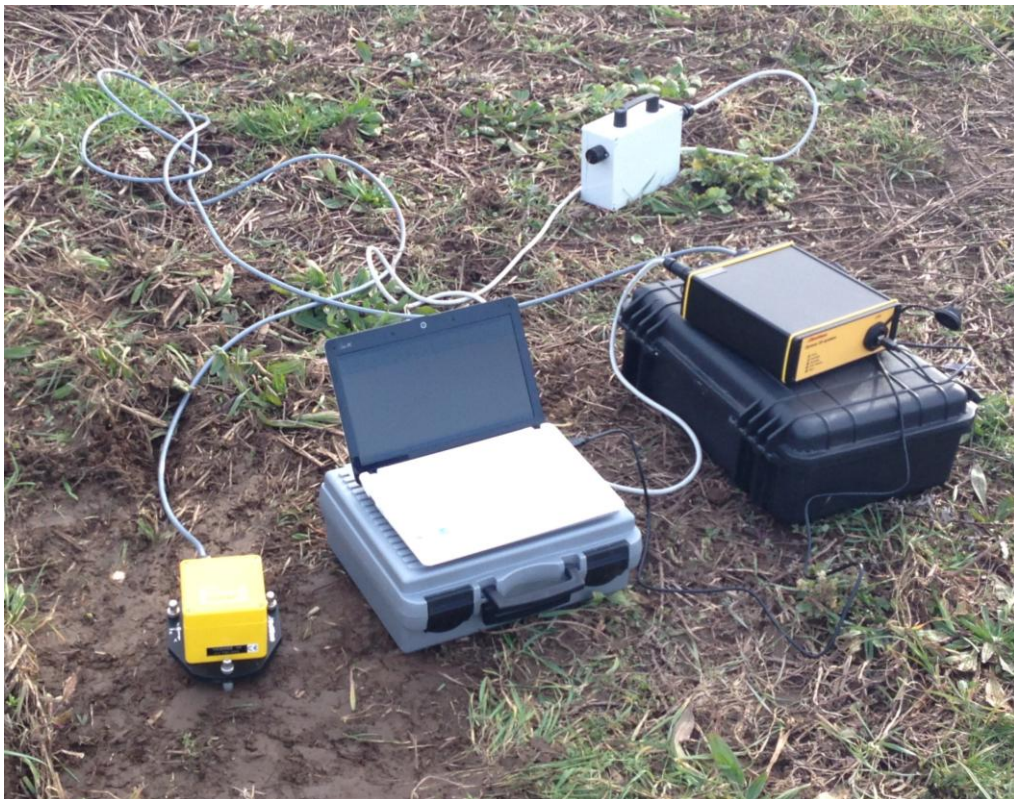
Sistema di acquisizione "Dymas-24" collegato a PC portatile e sismometro "Veloget3D" per misure di rumore ambientale a stazione singola (metodo HVSR)
