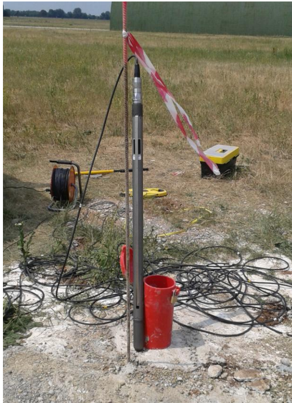
Geofono triassiale GHOSTUFF BHG-3 per prova sismica "down-hole"
