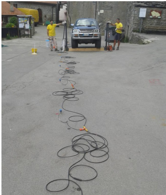
Prospezione sismica a rifrazione con onde SH - Dalli Sopra (Sillano – LU)
