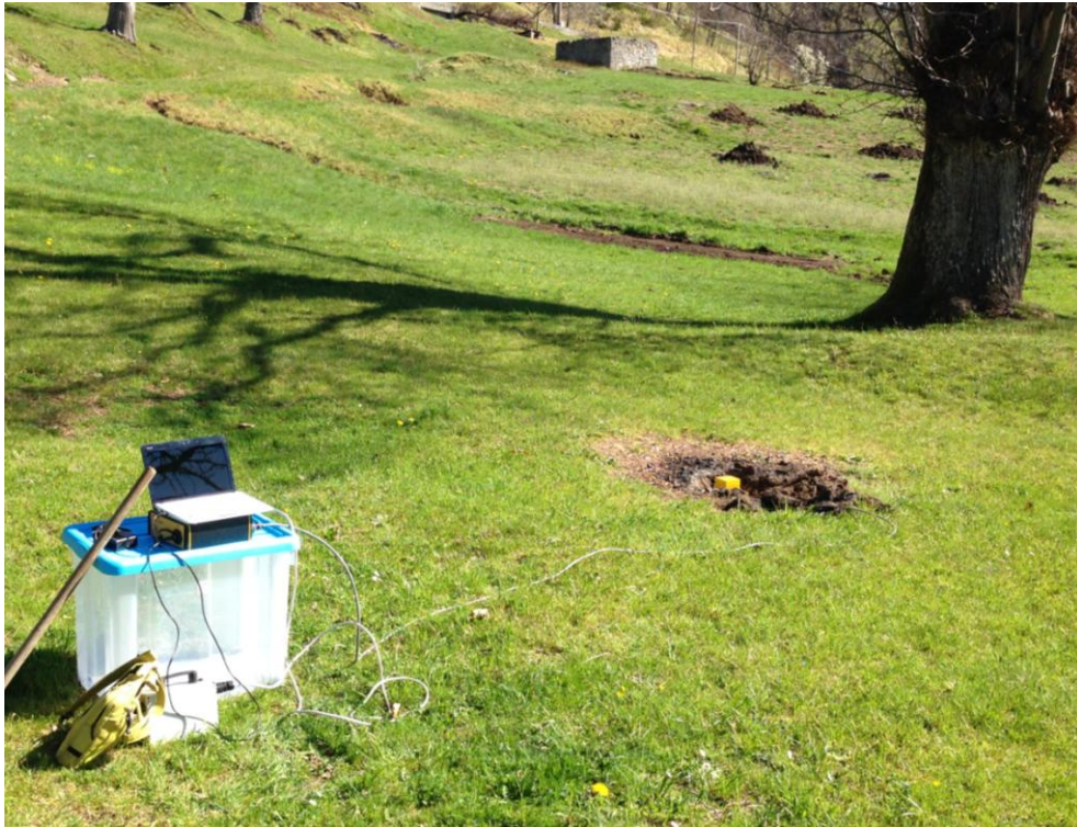
Misura di rumore ambientale a stazione singola (metodo HVSR) – Sulcina (Villa Collemantina – LU)
