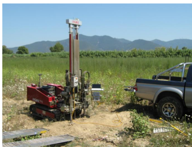
Prova penetrometrica statica con piezocono (CPTU) - argine del Fiume Arno, Cisanello (PISA): predisposizione del piezocono e delle aste di perforazione
