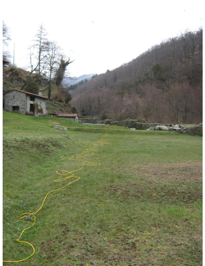
Indagine geoelettrica tramite stendimento multipolare polo-dipolo – Torrente Ania (Barga - LU)
