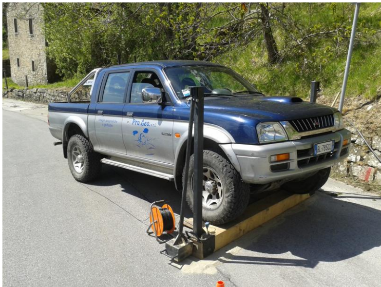
Sistema di energizzazione per onde trasversali SH
