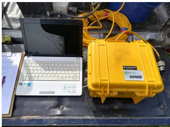
Sismografo Geometrics GEODE collegato a PC portatile
