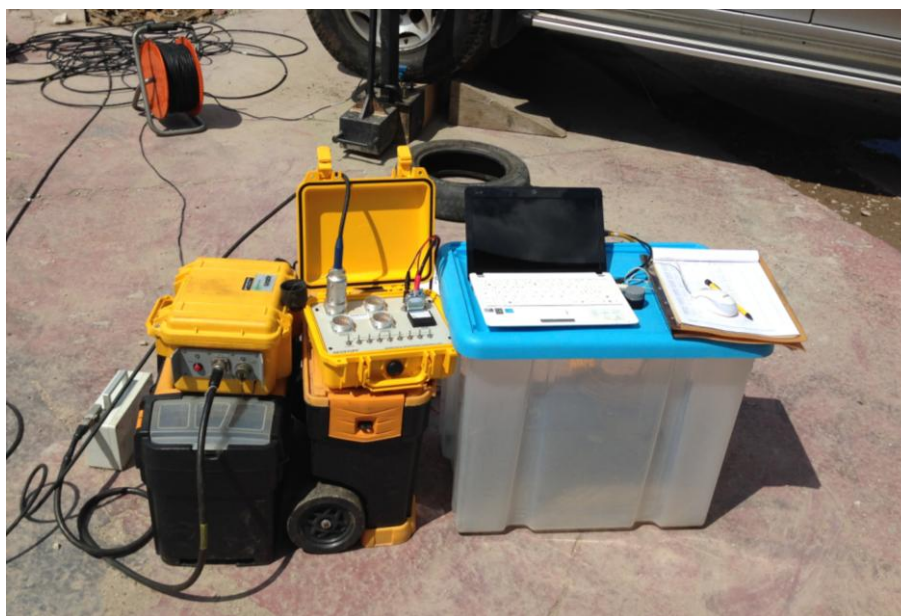
Strumentazione di acquisizione per prova sismica "down-hole" in foro: Sismografo GEOMETRICS GEODE - Unità di controllo BHGC-4 - PC portatile
