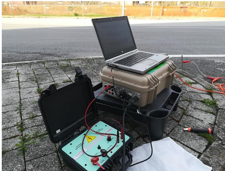
Georesistivimetro utilizzato per l'acquisizione dei dati (MANGUSTA MC48/E)
